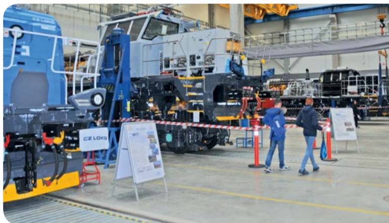
V montážní hale se montují pakety a dokončují lokomotivy. Byly v různém stadiu rozpracovanosti.
