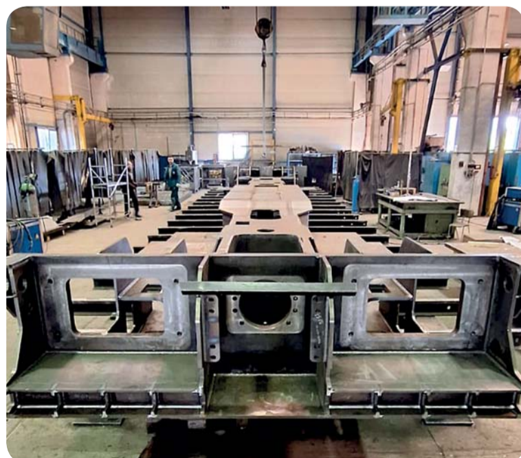
Svařenec hlavního rámu lokomotivy EffiShunter 1000 v rozpracovanosti.
