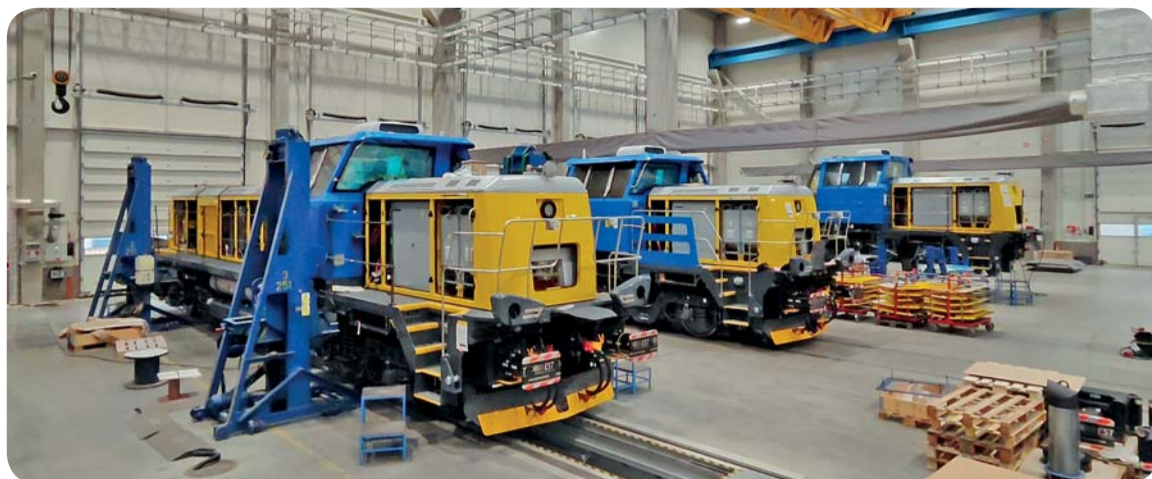
Rozpracovaná trojice lokomotiv EffiShunter 1000 pro GJW Praha v jihlavské provozovně.
